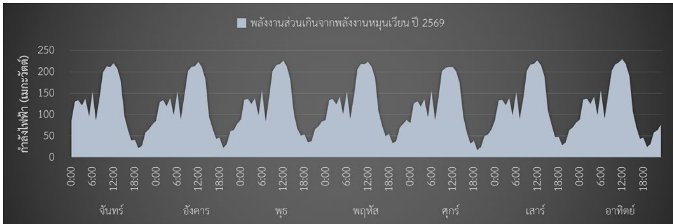
▲ รูปที่ 5.2-7 กราฟผลการคาดการณ์ศักยภาพกำลังไฟฟ้าพลังงานทางเลือกส่วนที่เกินจากความต้องการใช้ไฟฟ้า จังหวัดกระบี่ รายชั่วโมงในรอบสัปดาห์ ปี พ.ศ. 2569
