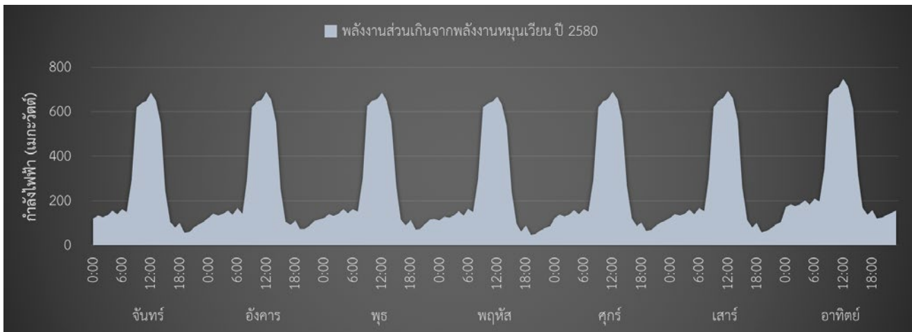
▲ รูปที่ 5.2-8 กราฟผลการคาดการณ์ศักยภาพกำลังไฟฟ้าที่ส่วนที่เกินความต้องการใช้ไฟฟ้าจังหวัดกระบี่ รายชั่วโมงในช่วงสัปดาห์ ปี พ.ศ. 2580
